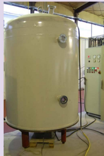
▲ Vakuumska komora sistema za plazma nitiranje "PLANIT 2002" sopstvene proizvodnje.
