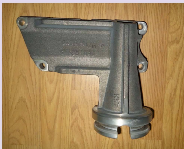
Nosač motora za BMW obrađen u GasTeh-u (Indija) plazma nitriran u Planitu.
