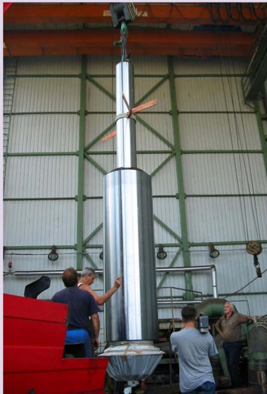
◀ Sanacija glavnog klipa (dužina 6000 mm, težina 17 tona) pri remontu prese za istiskivanje profila. Naručilac: Novkabel, Novi Sad
