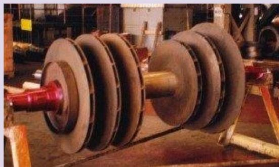
◀ Sanacija oštećenja nastalih elektroerozijom na rukavcima rotora kompresora kreš-gasa.
