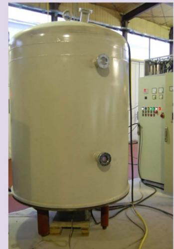
▲ Vakuumska komora sistema za plazma nitriranje "PLANIT 2002" sopstvene proizvodnje.
