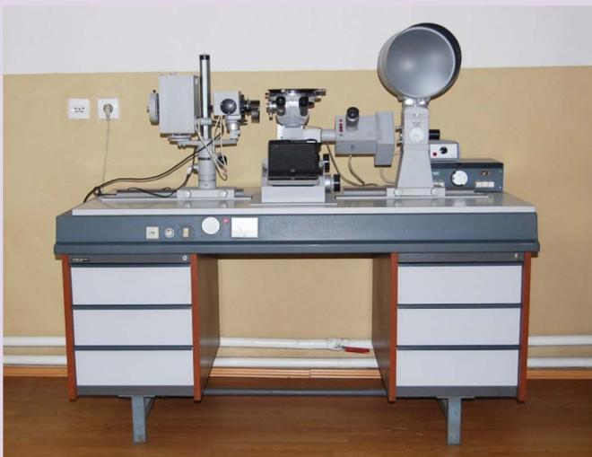
Metalografski mikroskop u laboratoriji Planita
